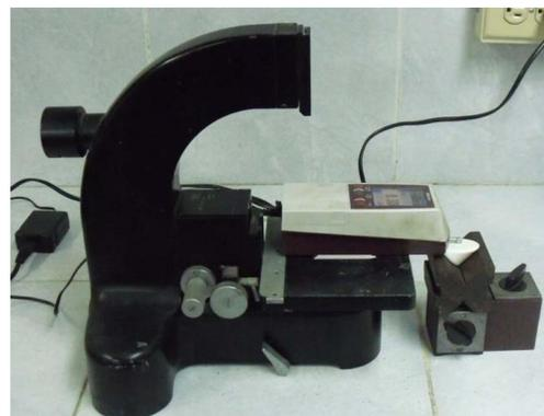
Figura 1. Instalación para la medición de la rugosidad.
