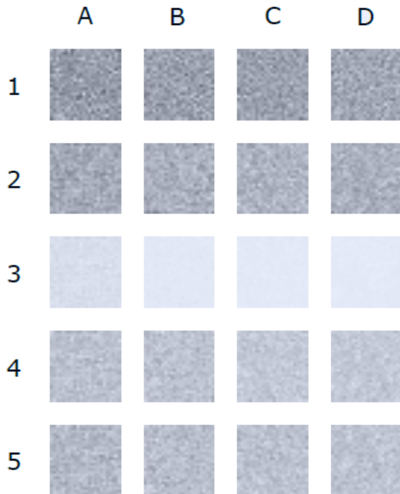
Figura 5. ROI # 1 (1- FBP, 2- ART, 3- SIRT, 4- SART, 5- CGLS) para el corte número 00 de cada protocolo de adquisición (a- 32keV y 800 proyecciones, b- 32keV y 1000 proyecciones, c- 35keV y 1000 proyecciones, d- 38keV y 1000 proyecciones).
