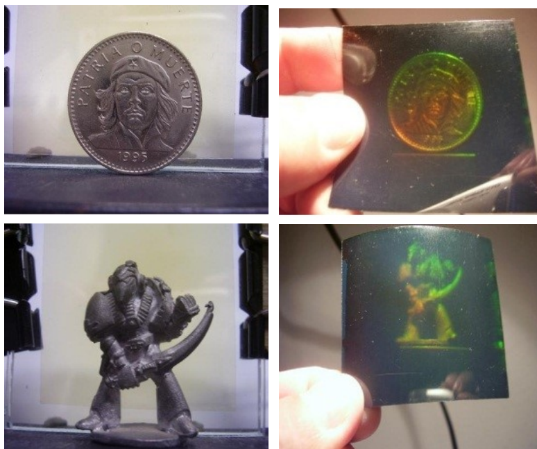
Figura 2. Objetos holografiados y hologramas obtenidos por primera vez en Cuba utilizando diodos láser
