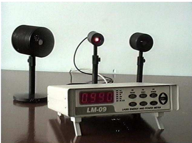
Figura 4. Medidor de energía y potencia láser LM-09 desarrollado por el Prof. Titular Juan Darías y colaboradores.
