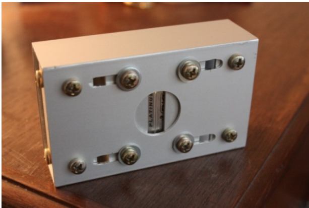
Figura 4. Sistema de entrada de luz (rendija) ajustable construido.
