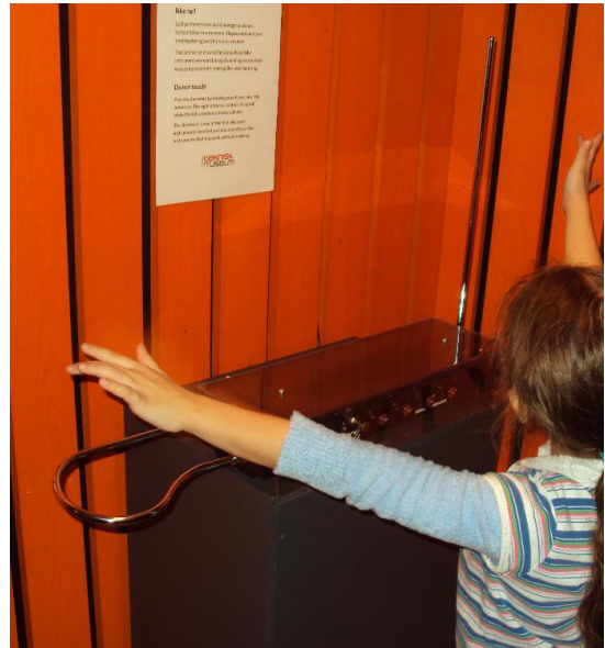
Figura 1. El “Theremin”: La física al servicio de la música. Este instrumento, concebido por el físico y músico soviético Lev Segueevich Termen en 1919, logra sonidos musicales derivados del efecto capacitivo del cuerpo humano sobre ondas electromagnéticas. En la foto, un ejemplar del instrumento que se expone en el Museo Nacional Noruego de Ciencia y Tecnología (foto: E. Artshuler).
