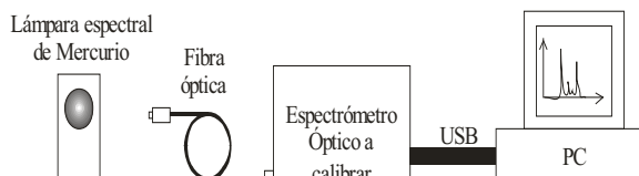
Figura 4. Montaje para calibrar el espectrómetro óptico
