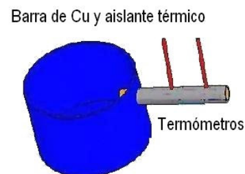
Figura 1. Esquema del montaje de laboratorio mostrando el recipiente contenedor de agua, los termómetros, la barra de cobre con su respectivo aislante térmico.
