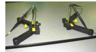
Figura 4. Montaje para la medición de la velocidad del sonido
