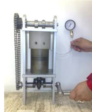
Figura 1. Fotografía del modelo de pistón didáctico con cilindro de resina.
