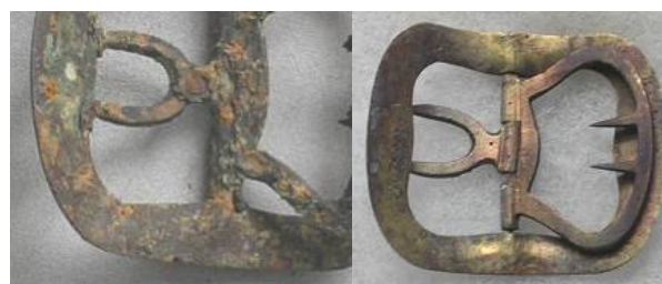
Figura 5. Limpieza con láser realizada a una hebillas. Antes (izq.) y después (der.) de limpiada.
