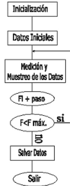
El primer bloque (*Inicialización*) es el encargado de inicializar el puente RLC y el puerto serie de la PC a través del cual se realizará la “comunicación”, estableciéndose parámetros como el número del puerto serie que se va a utilizar, la paridad, velocidad de transmisión, número de bits de datos y otros.
