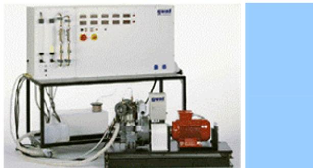
**Figura 2.** Banco de pruebas para motores de combustión interna.<sup>7</sup>
