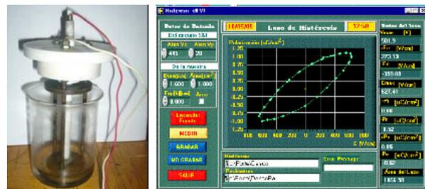
Figuras 2 y 3. Imagen del portamuestras de la instalación para medir el lazo de histéresis (Izq.). Pantalla del programa Lazo de Histéresis (Der).
