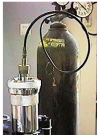
Figura 4. Cámara de reacción o bomba del calorímetro, recibiendo el oxígeno a 20 atmósferas.
