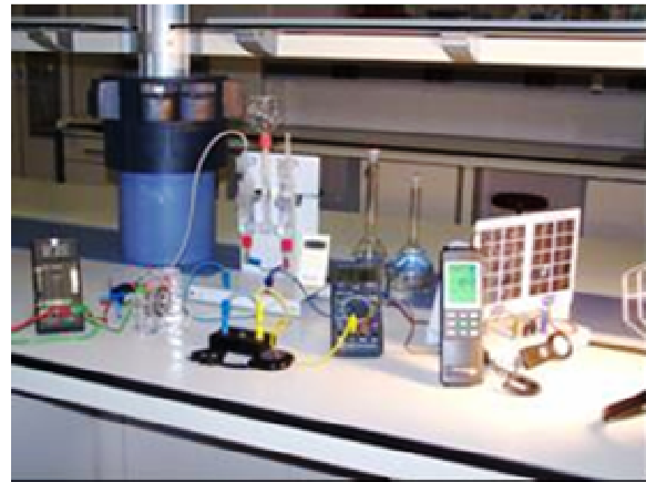
Figura 4. Experiencia con célula electrolítica solar.
