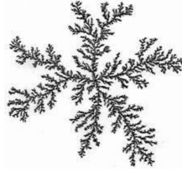
Figura 5. Patrón aleatorio obtenido por la simulación con el modelo DLA, para 10000 partículas
