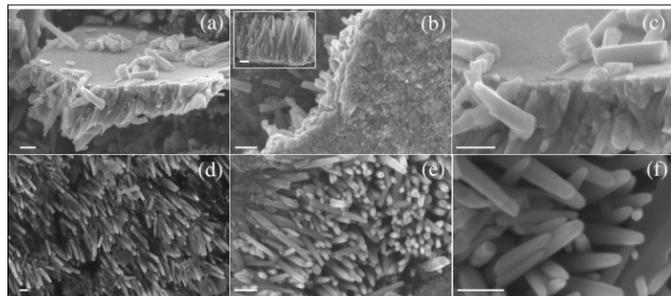
Figura 4. (a)-(c) Imágenes de SEM de las capas de semillas depositadas mediante el *spin-coating* libre de vacío. Se inserta en (b) detalles de un racimo de nanorods crecidos verticalmente sobre la capa de semillas. (d)-(f) Imágenes de SEM de nanovarillas de ZnO con incremento de la magnificación. Barra de escala: 200 nm).
