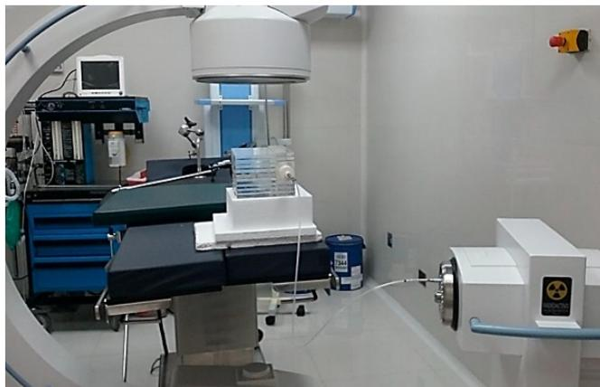
Figura 2. Configuración durante la irradiación de los OSL.
