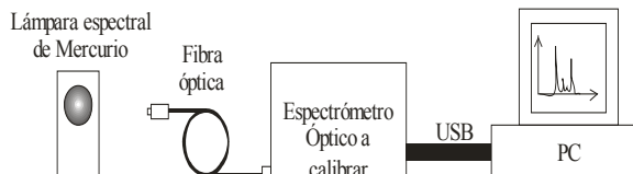
Figura 4. Montaje para calibrar el espectrómetro óptico
